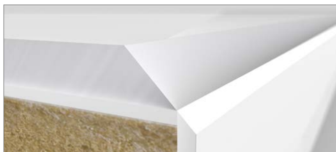
Abb. 8-18 Fazeta 45° probíhající přes hranu i povrch
