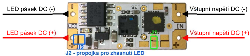
Obr.1 - Zapojení vývodů modulu
